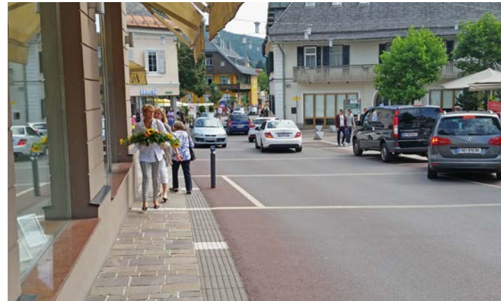
Abbildung 14: Der gepflasterte Bereich wird als Gehsteig, der asphaltierte Bereich als Fahrbahn interpretiert. Die geometrischen Markierungsmuster werden als Stellplätze fehlinterpretiert (Velden am Wörthersee).
