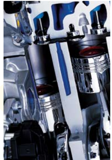
Bei jeder zweiten Umdrehung der Kurbelwelle wird der Verbrennungsraum gefüllt.
