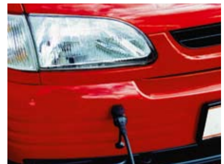
Elektrische Motorvorwärmanlagen benötigen einen Stromanschluss
