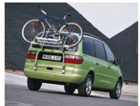
Fahrradträger am Dach oder am Heck vergrößern den Luftwiderstand.
